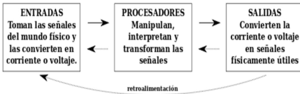
Como ejemplo supongamos un televisor. Su entrada es una señal análoga recibida por una antena o por un cable. Los circuitos integrados del interior del televisor extraen la información sobre el brillo, el color y el sonido de esta señal. Los dispositivos de salida son una pantalla LED que convierte las señales electrónicas en imágenes visibles en una pantalla y unos altavoces.
