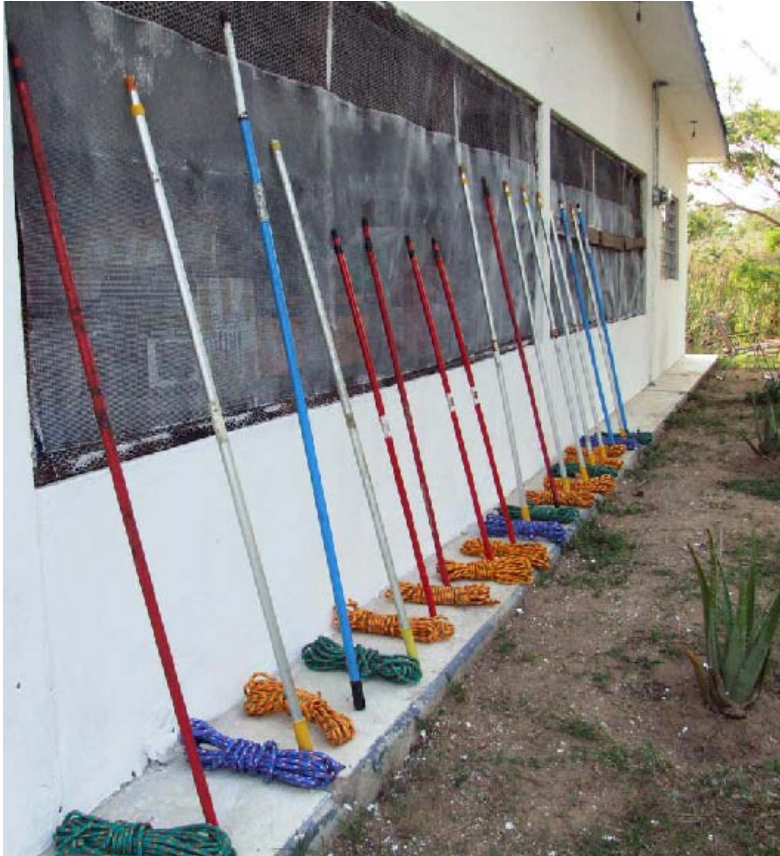
Figura 5.5. Diferentes tipos de pértigas para el manejo de cocodrilos. Las de color rojo son de material plástico, las de color azul de material metálico/acero y las de color gris de aluminio. Cualquiera de ellas puede ser de una pieza o extensibles de entre 1.5 y 3 m.
